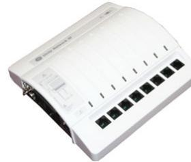
Das Unity Network ID-Anschlussgerät erfasst digitale Daten von acht einzelnen isolierten seriellen Anschlüssen. Die Daten werden von bis zu acht Peripheriegeräten erfasst (die nicht von GE stammen müssen). Anschließend überträgt das Gerät die formatierten Daten an den Monitor.
